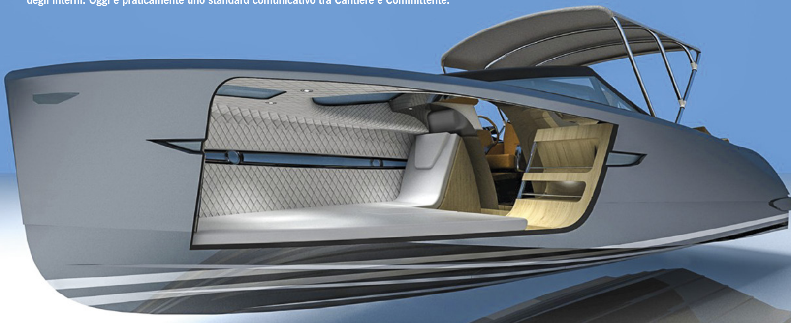
Il Barracuda B27. Rendering con sezione spaccata per la rappresentazione grafica dell'arredo degli interni. Oggi è praticamente uno standard comunicativo tra Cantiere e Committente.
